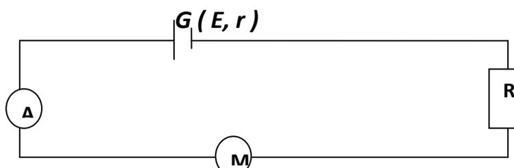
1 – On empêche le moteur de tourner (moteur calé) . L'ampèremètre indique  $I = 3 \text{ A}$
