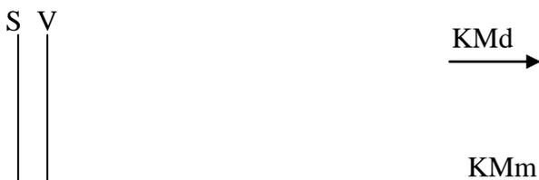
d – sachant que  $KMd = S \cdot \bar{V}$  et  $KMm = \bar{S} + V$ , écrire ces équations en utilisant des opérateurs NOR :
