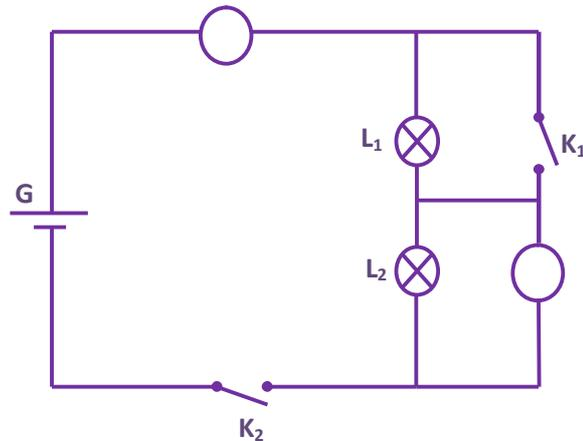
1) Ajouter à ce circuit la lettre **A** pour indiquer la place de l'**ampèremètre** et la lettre **V** pour celle du **voltmètre**.
