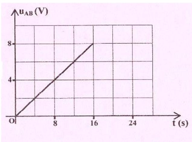
A l'instant  $t=0$ , on place le commutateur  $K$  en position (1). A l'aide d'un dispositif approprié, on suit l'évolution temporelle de la tension  $u_{AB}$  aux bornes du condensateur et on trace la courbe de la **figure-2**.
