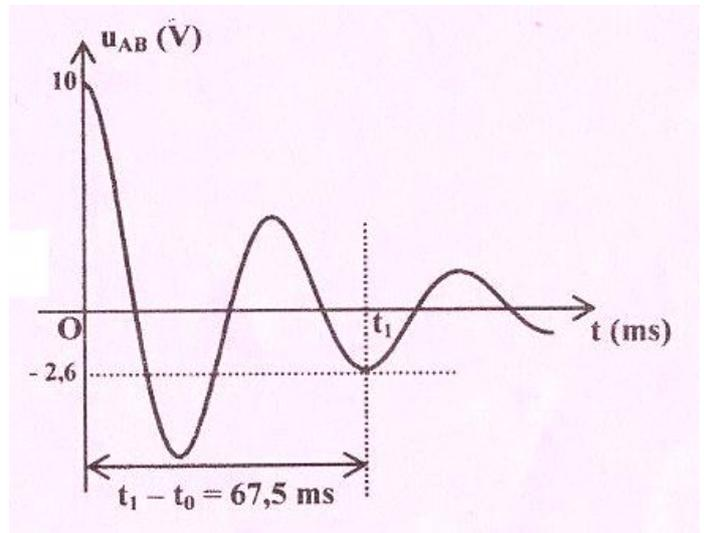
**III- Troisième expérience :** On réalise le circuit de la **figure-4**, ou ( $G_2$ ) est un générateur idéal de tension de fém. **E** et **K'** un interrupteur. A un instant  $t=0$ , on ferme **K'** et à l'aide d'un dispositif approprié on suit l'évolution de la tension  $u_{DB}$  aux bornes de la bobine et on trace la courbe correspondante, on obtient la courbe de la **figure-5**. On trace la tangente ( $\Delta_0$ ) à cette courbe au point d'abscisse  $t=0$ .
