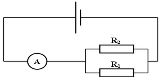
3) Comparer les intensités du courant  $I$  et  $I'$ . En déduire une comparaison entre les intensités du courant débité par le même générateur dans un circuit en série et un circuit en dérivation comportant les mêmes dipôles.
