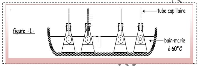
A différentes dates , on retire un erlenmeyer du bain marie , on lui ajoute de l'eau glacée pour bloquer l'évolution de la réaction , puis on dose la quantité d'acide formé avec une solution de soude.
