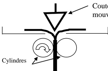
Le papier est amené sous "une lame" de couteau qui vient le déformer pour l'insérer entre deux cylindres. Le pli est ainsi formé et la feuille est éjectée vers la sortie.
