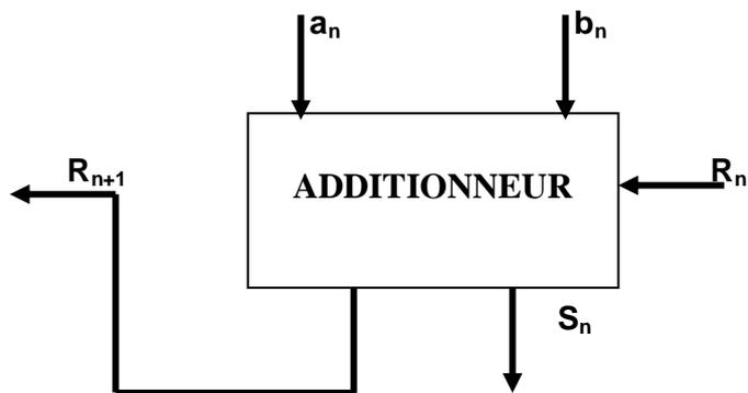
1°) En utilisant le modèle décrit ci-dessus, établir le circuit matérialisant l'addition de (A + B).
