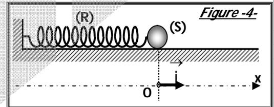
On écarte (S) de sa position d'équilibre O ( avec O origine du repère (O, i) ) dans le sens de l'allongement du ressort d'une distance  $X_m$  et on l'abandonne à lui-même à l'instant de date  $t=0$ , sans vitesse initiale.
