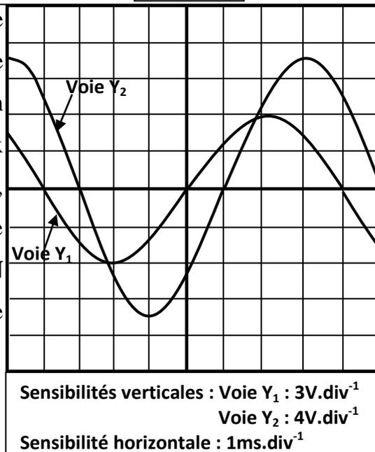
Pour une valeur  $N_1$  de la fréquence du générateur, un ampèremètre branché en série indique  $I=1A$ , un voltmètre branché aux bornes du résistor indique  $U_R=2,5V$  et on obtient les oscillogrammes de la figure 1.
