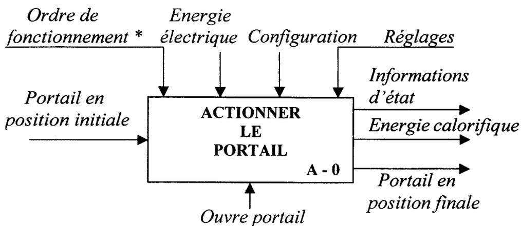
\*Ordre de fonctionnement = ondes radio émises ou l'un des deux boutons poussoirs enfoncés (ouverture ou fermeture)
