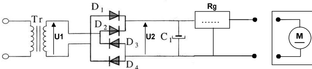
1. Sachant que le secteur de la **STEG** fournit une tension alternative de **220 V** et le moteur fonctionne avec 24 V, donner dans l'ordre les fonctions qui constituent cette alimentation stabilisée.
