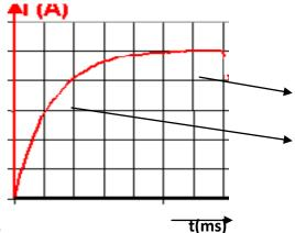
Une bobine s'oppose aux variations de l'intensité du courant dans le circuit.
