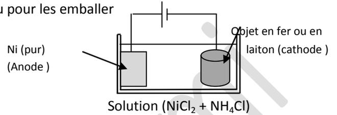
Après une durée  $\Delta t$  l'objet en fer se recouvre d'une couche en nickel mince et adhérente
