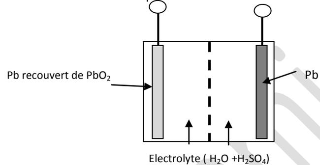
La batterie de démarrage d'une voiture est une association en série d'un certain nombre d'éléments d'accumulateur en plomb, ce dernier comprend deux électrodes et possède une f.e.m. proche de 2 V en décharge. Chaque électrode est constituée de plusieurs plaques reliées électriquement :
