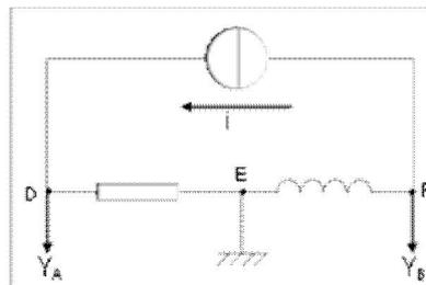
Un oscilloscope permet de relever la tension entre les bornes de la bobine et celles de la résistance. Le générateur de courant est à masse flottante : sa masse électrique n'est pas reliée à la borne terre (la tige métallique des prises de courant).
