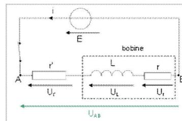
Vous admettez que la solution de l'équation différentielle précédemment établie :  $\frac{di}{dt} + \frac{r+r'}{L}i = \frac{E}{L}$  est de la forme :  $i(t) = Ae^{\alpha t} + B$ .
