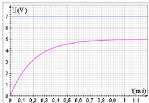
2°) On a représenté les tensions visualisées sur les voies A et B lors de la fermeture de l'interrupteur à l'instant  $t=0$ . Calculer l'intensité (notée  $i_p$ ) lorsque le régime permanent est établi, sachant que  $R = 100 \Omega$ .
