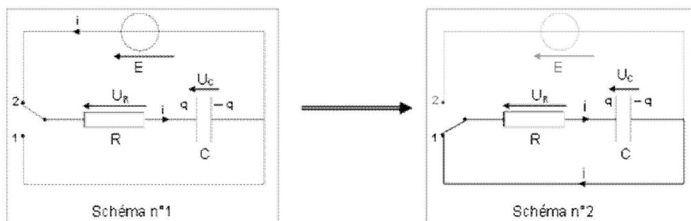
*Remarque :* Lorsque  $U_c = E$ , on a aussi  $U_R = 0$  donc  $i = 0$ . Plus aucun courant ne traverse le condensateur ; la charge de ce dernier est alors terminée.
