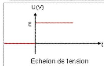
Vous admettez que la solution de l'équation différentielle :  $\frac{dU_c}{dt} + \frac{U_c}{RC} = \frac{E}{RC}$  (ou  $E = U_c + RC \frac{dU_c}{dt}$ ) est de la forme :  $U_c(t) = Ae^{\alpha t} + B$  ( $\alpha$  : lettre grecque « alpha »)
