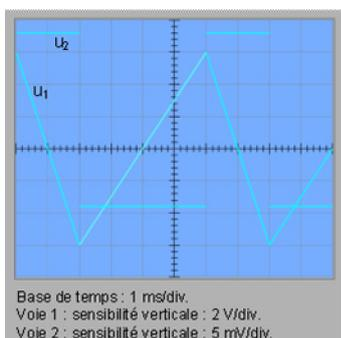
On branche en série, aux bornes d'un générateur, un conducteur ohmique de résistance  $R = 1,0 \text{ k}\Omega$  et une bobine d'inductance  $L$  et de résistance négligeable. Les tensions  $u_1$  et  $u_2$  sont appliquées aux bornes d'un oscilloscope. Les oscillogrammes obtenus sont donnés ci-contre.
