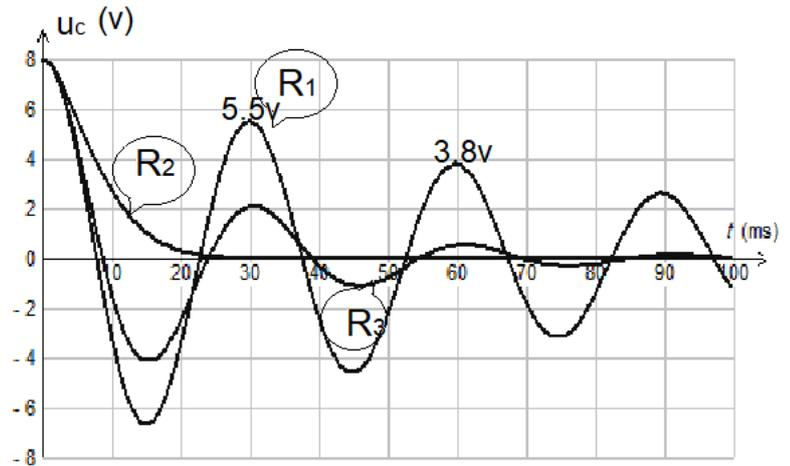
On charge un condensateur de capacité  $C=28 \mu\text{F}$  avec un générateur de tension de f.e.m  $E$  puis on le place en série avec une bobine idéale d'inductance  $L$ , un conducteur ohmique de résistance  $R$  réglable et un double interrupteur  $K$ . A la date  $t=0$ , on ferme l'interrupteur  $K$  sur la position 2. la tension  $u_c$  aux bornes du condensateur est visualisée à l'aide d'un oscilloscope à mémoire. On réalise plusieurs mesures en utilisant des valeurs de  $R$  différentes.
