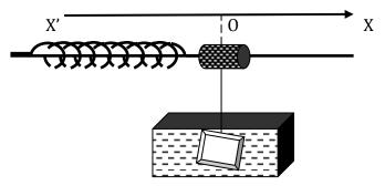
Au cours de son mouvement, S est soumis à une force de frottement f = -hV ou h est une constante positive caractéristique du liquide et de la forme de la plaque P et V la vitesse du centre d'inertie G.
