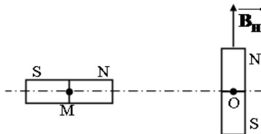
– Calculer la valeur du champ magnétique  $\vec{B}_1$  créé par l'aimant au point  $O$ , ainsi que celle de  $\vec{B} = \vec{B}_1 + \vec{B}_H$ .
