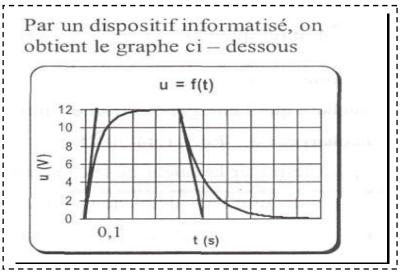
Le passage non instantanée de l'interrupteur inverseur K de la position 1 à la position 2 se fait entre les dates :  $t_1$ =300ms et  $t_2$ =400ms.
