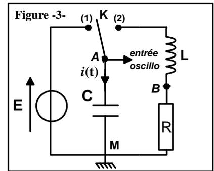
**-1-** Lorsqu'on ferme le commutateur  $K$  sur la position (1), on remarque que la tension  $u_{AM}$  s'établit instantanément. Interpréter ce résultat.
