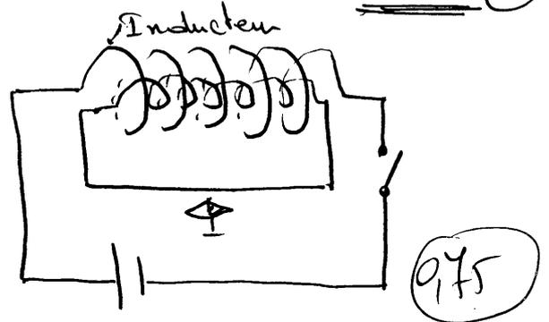
En fermant et en ouvrant l'interrupteur l'aiguille dévie.
